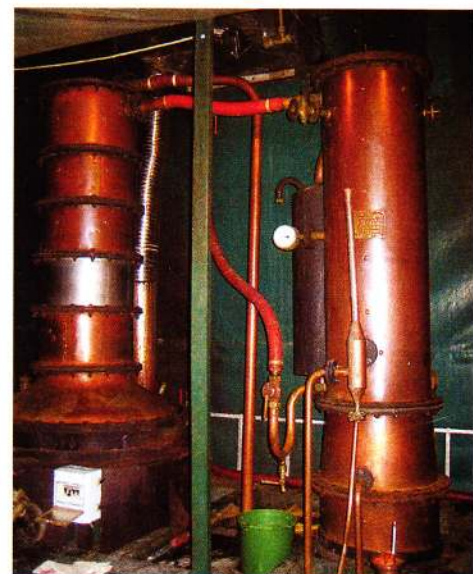
Alambic servant à la fabrication du Ratafia, à base de marc de Champagne.
